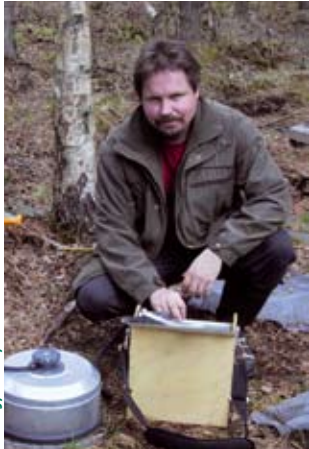
Suopellon maahengitystä mitataan infrapuna-kaasuanalysointilaitteella
