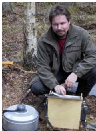
Suopellon maahengitystä mitataan infra-punakaasuanalysointilaitteella (Kuva: Jyrki Hytönen)
