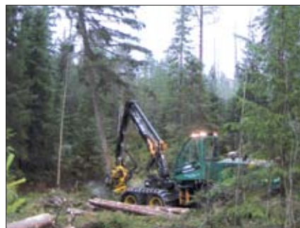
Kuva 3. Hakkuukoneella mitatun runkopuun määrän perusteella voidaan arvioida latvusmassan ja kantojen määrää korjuun ja kuljetuksen suunnittelun ja energiapuukaupan tueksi. Varsinaista mittausmenetelmää ei ole olemassa. Kuva: Metla/Jari Lindblad.
