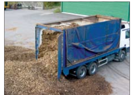
Kuva 4. Metsähakkeen tilavuuden mittaus kuormatilassa on yleisesti käytetty ja tarkkuudeltaan riittävä menetelmä määrittää energiapuun määrää. Kuva: Metla/Jari Lindblad.
