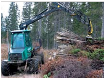
Kuva 2. Kuormainvaakojen yleistyminen tarjoaa uusia mahdollisuuksia energiapuun mittauksen toteuttamiselle. Tarvittaessa kuormainvaalla punnittu massa voidaan muuntaa tilavuudeksi tuoretiheysluvulla. Kuva: Metla/Juha Laitila.
