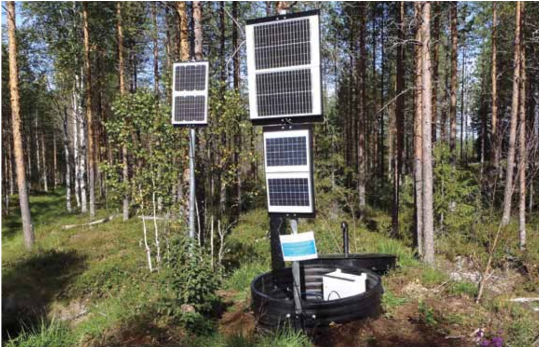
Kuva 6. Jatkuvatoiminen mittaustilasto tarvitsee virtaa, jota syrjäisissä metsissä helpoiten saadaan auringosta ja akuista. Aurinkopaneelit tulee asentaa paikkaan, jossa ei ole varjoisaa (kuva Minna Kukkonen).
