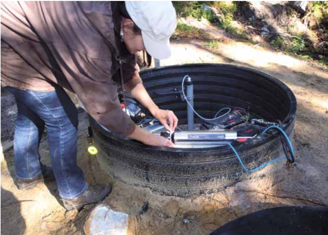
Kuva 7. Anturit tulee puhdistaa riittävän usein, jotta mittaustarkkuus säilyy (kuva Minna Kukkonen).
