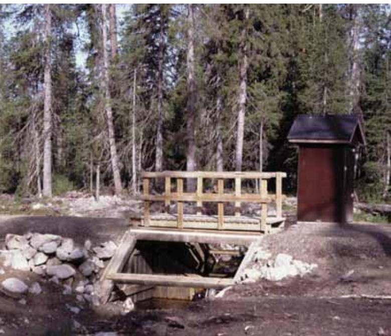
Kuva 2. Vasemmassa kuvassa mittapato sekä vedenlaadun seuranta-asema (kuva Erkki Oksanen) ja mittakaivon asennus oikeassa kuvassa (kuva Leena Finér). Mittalaitteisto asennetaan mittakaivon sisään.
