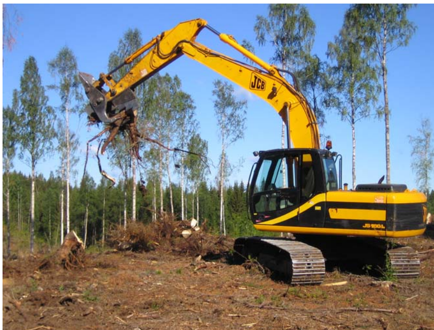
Kuva 1. ”Kantokunkku” kantoharvesteri JCB-kaivukoneeseen asennettuna (Ala-Fossi 2006).
