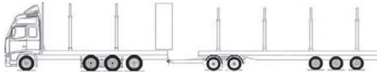
Kuva 3. ST-kuormainautoyhdistelmä, joka koostuu kuormaimella varustetusta kuorma-autosta, apuvaunusta ja puoliperävaunusta (kuva: Löfroth & Svenson 2012).
